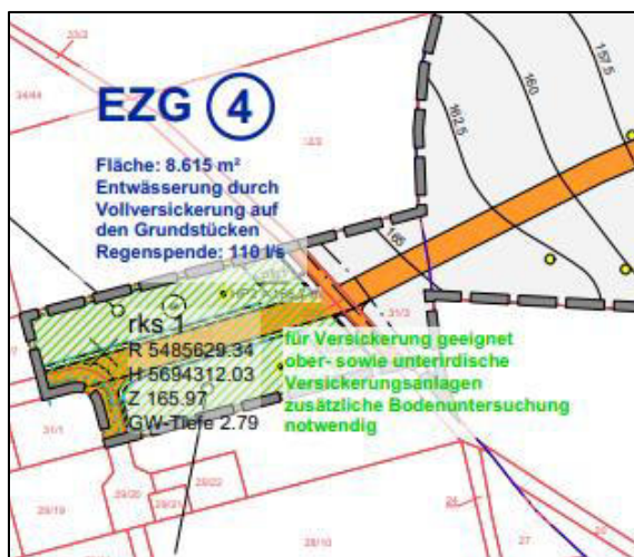
Abbildung 5 Lageplan mit versickerungsgerechten Flächen (EZG 4)
